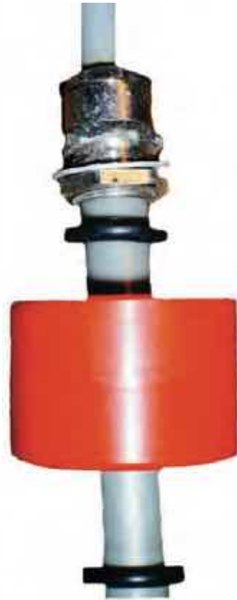
Dieses Schwimmerventil schaltet die Füllpumpe beim Erreichen des Wasserstandes ab.
