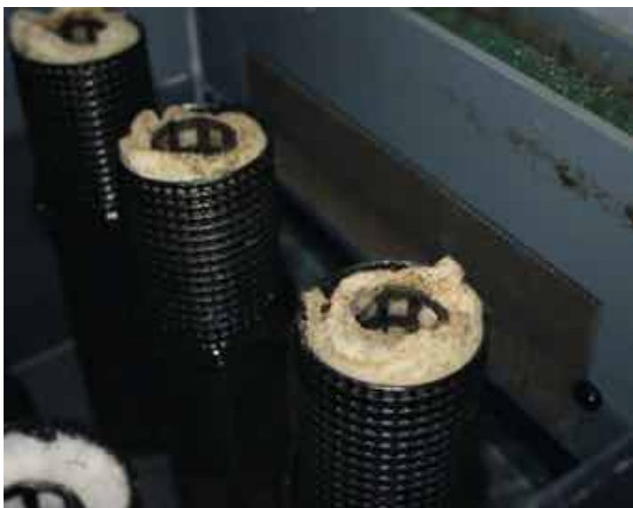
Das VA-Feinfiltersieb befindet sich in der Öffnung zur Hauptfilterkammer sowie in gleicher Höhe und Größe (auf dem Bild nicht zu erkennen) in der Einlaufkammer. Auf diesem Weg, durch beide VA-Feinfiltersiebe und dem Filterschwamm gelangt das Wasser in die Hauptfilterkammer.
