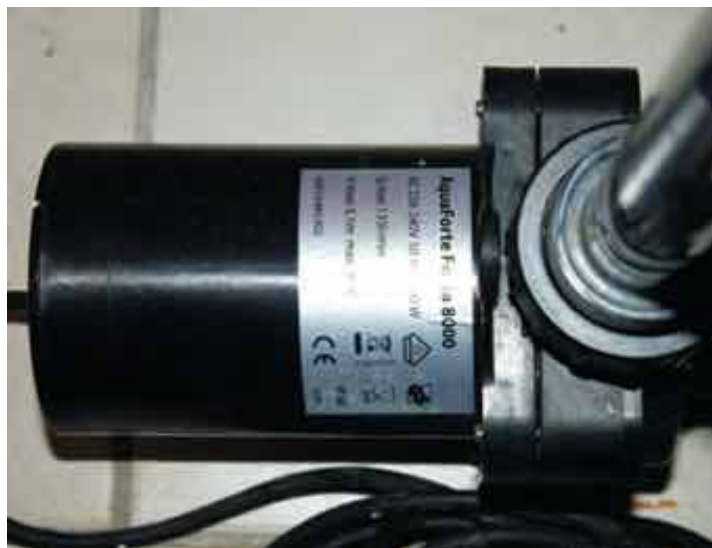
Die Förderpumpe mit 8000 l/h Förderleistung ist außen am Filter angeschlossen. Bei dieser Förderleistung ergibt sich ein Hub (Überstand über der Ablaufbohrung) von 23 Millimeter in jedem Becken der Anlage.
