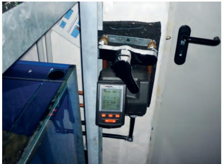
Mit dem Gardena Bewässerungscomputer Multicontrol Duo können zwei unterschiedliche Kreisläufe gesteuert werden. So sind Wasserwechsel auch während meiner Abwesenheit möglich.
