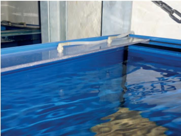
Die Wassereinläufe auf dem Becken. Ein mit Silikon aufgeklebter Kunststoffstreifen (Makrolon) mit eingeschraubtem Anschlusswinkel. Die Verbindung vom T-Stück zum Anschlusswinkel besteht aus 4/6er Luftschlauch.
