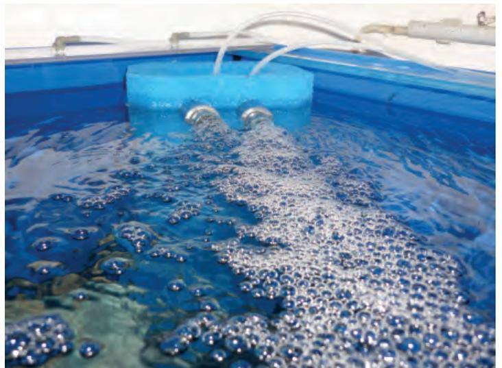
Luftbetriebene HMF-Filter befüllt mit SIPORAX-Mini mit zwei und drei Antrieben sorgen für die Filterung und eine gute Wassenumwälzung / Strömung.
