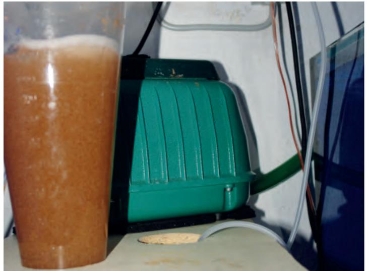
Das Regal mit der Membranpumpe lässt sich zusätzlich mit Brutkegeln für Artemia bestücken, die in entsprechenden Bohrungen sitzen.
