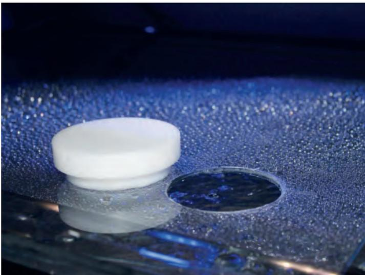
Abdeckplatten aus Kunststoff (Makrolon), die zum besseren Handling geteilt wurden. Um sie zum Füttern nicht abnehmen zu müssen, wurden Bohrungen (7 cm) eingebracht, die mit Kunststoffkappen verschlossen werden.
